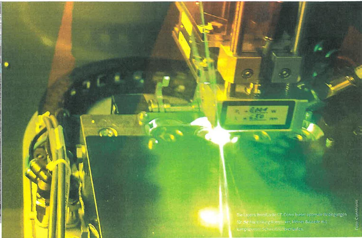
Die Laserschweißzelle CT-Conni bietet optimale Bedingungen für die Herstellung komplexer, kleiner Bauteile mit komplizierten Schweißnahtverläufen.
