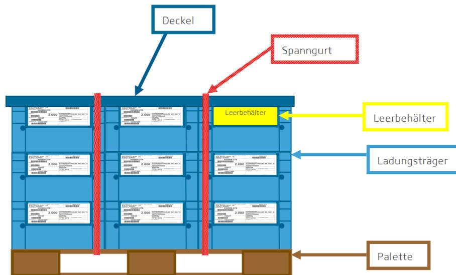
Abbildung 1: Beispiel für Belabelung und Kennzeichnung von Leerbehältern
